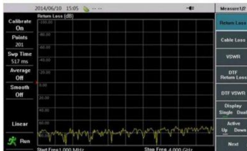
Рис.1 Измерение обратных потерь в S3101
