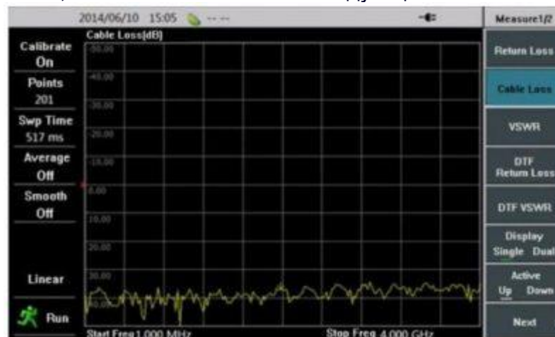
Рис.2 Измерение потерь в кабеле при помощи S3101
